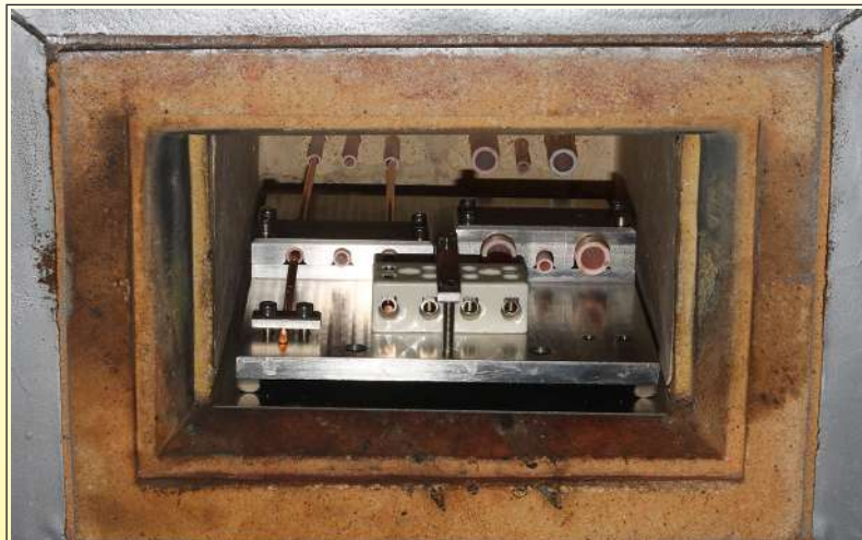
Prüföfen für den spezifischen Widerstand von Keramik in Abhängigkeit von der Temperatur (Ultimheat Labor)
